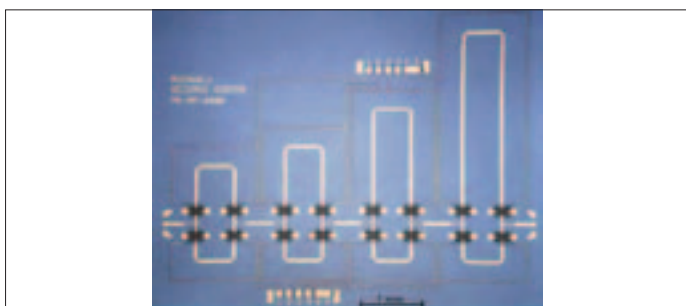
Рис.6. Линия задержки сигнала миллиметрового диапазона с четырех-разрядным управлением МЭМС-ключами
